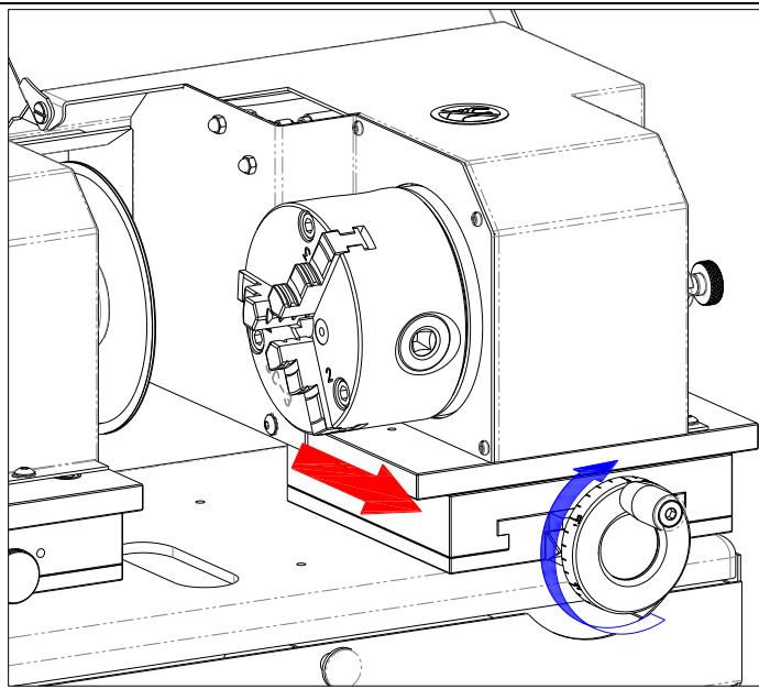
逆時鐘方向旋轉手輪，Y軸向前方向移動
