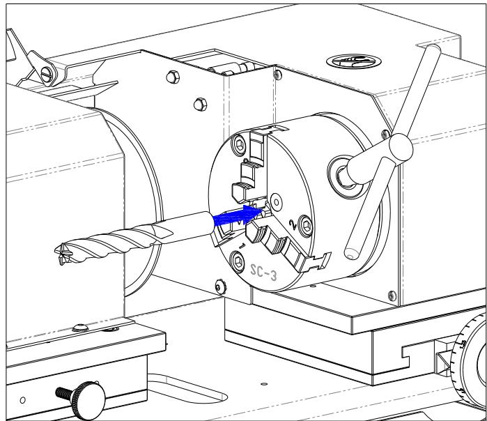
鎖緊夾盤來固定工件
