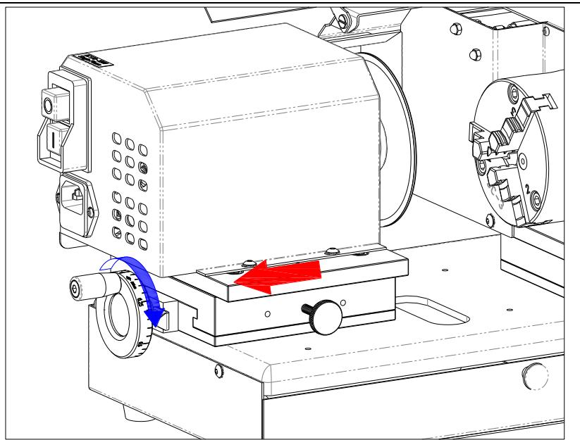
逆時鐘旋轉手輪, X軸向右方向移動
