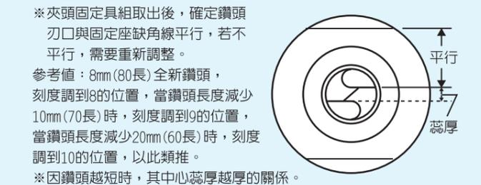
5. 啟動開關馬達迴轉安定時(約10秒鐘)，將夾頭固定具組置入第I研磨座，固定具組缺口部位對準研磨台之2支插銷後，輕輕推砥磨石左右轉動緩緩向前推到底，直到研磨聲音靜止取出，再轉180度，以同樣方式研磨到無聲為止。
